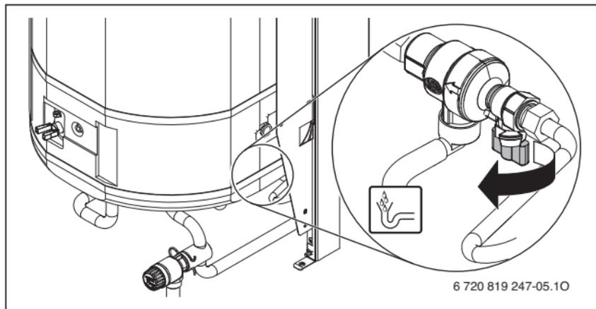
Fig. 6 Dispositif de remplissage du ballon BIL50M
