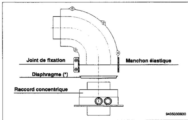
(\*) Le diaphragme présent dans la chaudière ne doit être enlevé que si la longueur du conduit d'évacuation dépasse 1,5 m.
