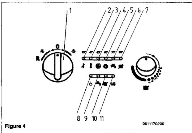
Les signalisations 2+7 montrent la température atteinte par l'installation de chauffage. En cas d'anomalie de fonctionnement, le type de défaut est visualisé par une signalisation CLIGNOTANTE.
