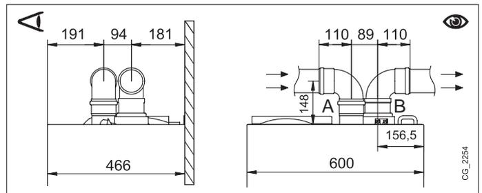
Le coude à 90° permet de raccorder la chaudière aux conduits d'évacuation et d'aspiration selon les différentes exigences. Il peut également être utilisé comme coude supplémentaire à accoupler au conduit ou au coude à 45°
