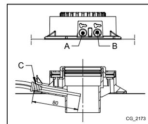
La température de l'air comburant doit être relevée dans la prise raccordée au circuit d'aspiration de l'air (B), en introduisant la sonde de mesure pour environ 8 cm (C).
