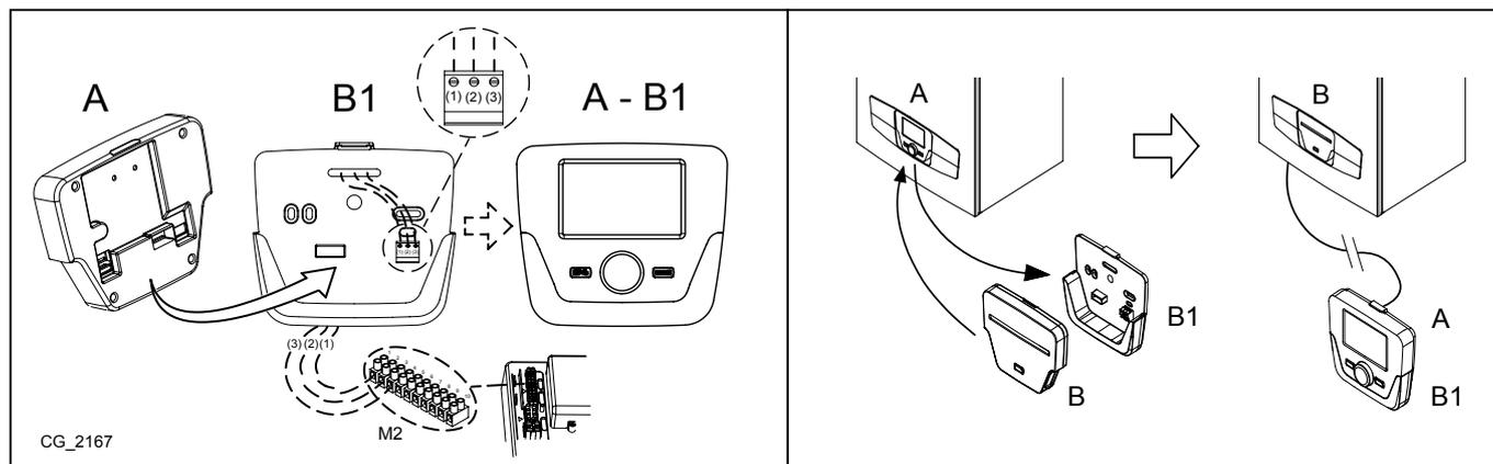
**!** Le câble (1) provenant du bornier M2 de la chaudière assure l'alimentation électrique (12 V) pour le rétroéclairage de l'afficheur. Le branchement de ce câble n'est pas indispensable pour le fonctionnement du Panneau de Commande.
