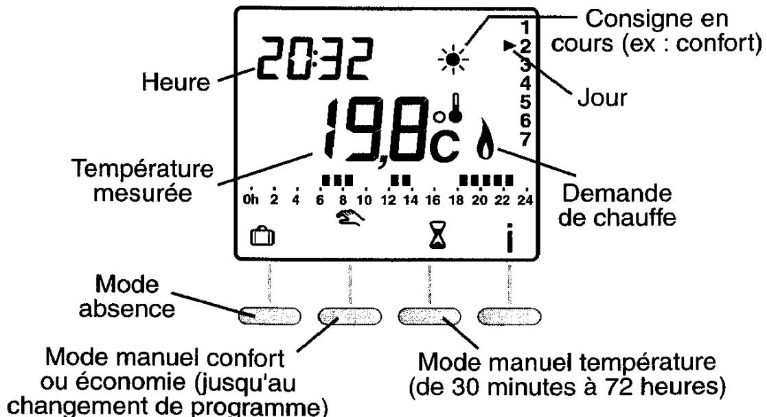
A la mise en service, la température mesurée par le thermostat s'affiche (le symbole apparaît au-dessus du °C).
