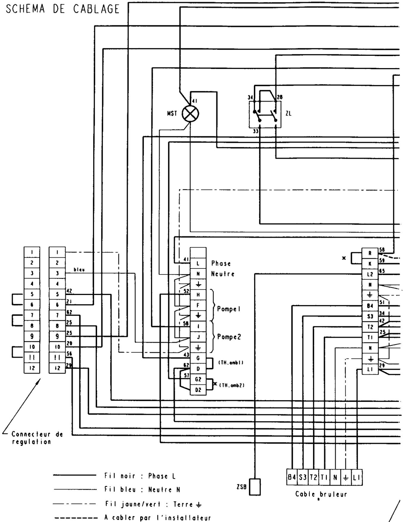
\* Nota : les pontets R-K et D2-G2 sont à retirer dans le cas de l'installation d'une Régulation proposée au Tarif
