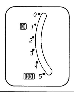
La commande de la vanne trois voies permet d'adapter la chaudière aux besoins thermiques de l'installation (voir tableau de positionnement de la vanne dans le paragraphe "Fonctionnement en mode Hiver"). Le réglage manuel pour adapter la chaudière aux conditions climatiques peut devenir automatique avec une motorisation de la vanne trois voies et un thermostat spécialement conçu à cet effet (disponible en option).
