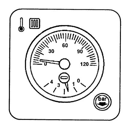
La partie basse du tableau de commande indique la pression et la température de départ du circuit chauffage.
