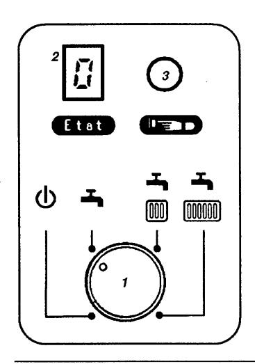
La partie centrale du tableau de commande vous permet de sélectionner avec l'interrupteur 1 du mode de fonctionnement la fonction: En attente, Eté, Hiver froid et Hiver très froid. L'écran d'affichage 2, signale les états de fonctionnement comme les état de défaut. Le bouton de réenclenchement 3 vous permet de réinitialiser la chaudière après un défaut. Les codes d'affichage d'un fonctionnement normal sont indiqués par les signes suivants:
