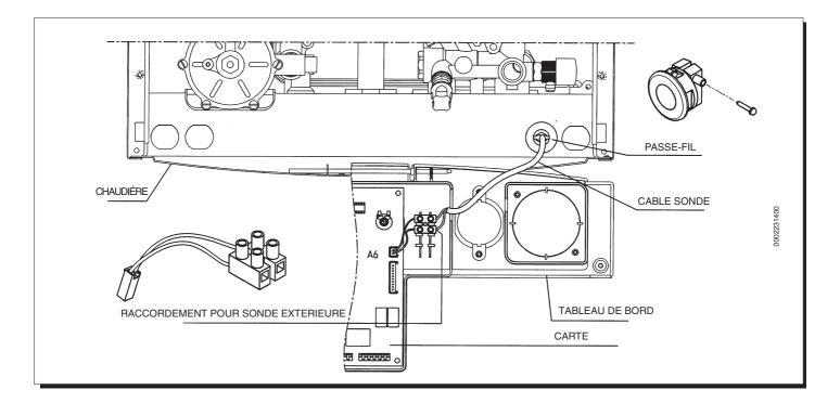
Le dispositif de régulation de la température du circuit de chauffage a pour fonction de régler le coefficient de déperdition Kt, la sonde extérieure étant connectée.
