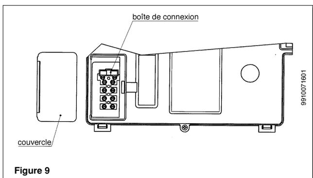
Le fusible instantané de 2 A est incorporé dans le bornier d'alimentation (extraire le porte-fusible de couleur noire pour le contrôle et/ou le remplacement).
