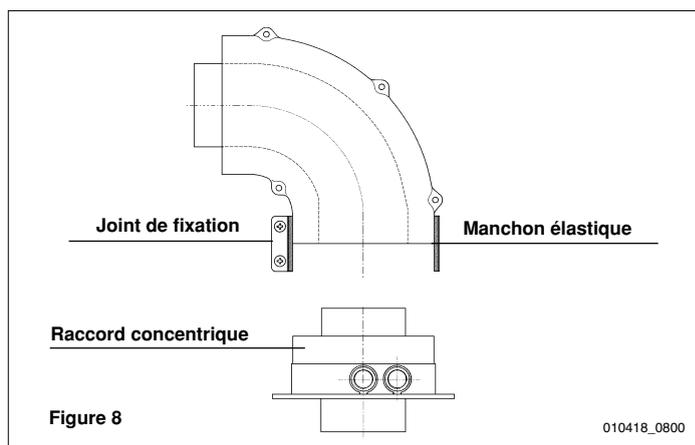
En cas d'évacuation vers l'extérieur, le conduit d'évacuation-aspiration doit déborder du mur d'au moins 18 mm. afin de permettre le positionnement de la rondelle de scellement au mur en aluminium, pour éviter les infiltrations d'eau. La pente minimum de ces conduits vers l'extérieur doit être égale à 1 cm. par mètre de longueur.
