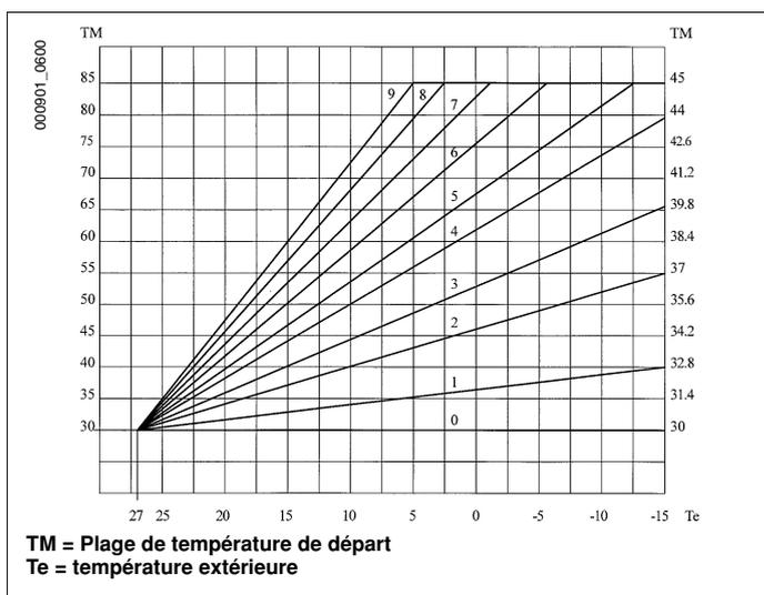
**IMPORTANT:** la valeur de la température de refoulement  $T_M$  dépend de la position du pontage ou du switch T.RISC. (voir chapitre page 13). La température maxi programmable peut être, en effet, de 85 ou 45°C.
