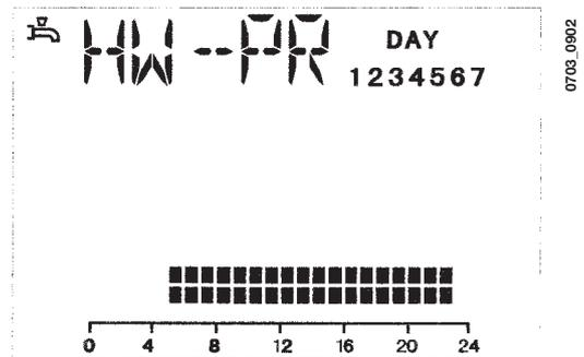
**IMPORTANT:** pour activer la programmation hebdomadaire, l'installateur doit programmer le paramètre "HW PR" = 2, ainsi qu'il est décrit au paragraphe 29.
