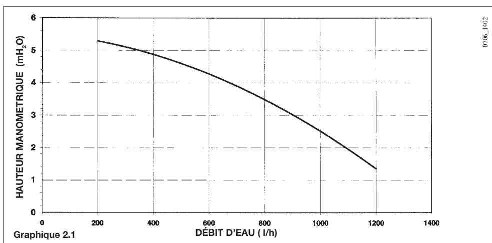
**AVIS:** pour le correct fonctionnement de la chaudière il faut garantir que le débit d'eau minimal du circuit de chauffage soit de  $\geq 600$  l/h.
