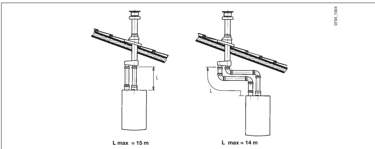
**Important** : le conduit simple pour l'évacuation des gaz brûlés doit être isolé correctement sur les points où il entre en contact avec les parois de la maison (couche épaisse de laine de verre par exemple). Pour plus de détails sur les modalités de montage des accessoires, voir les notices techniques qui accompagnent ces mêmes accessoires.
