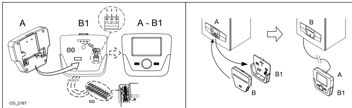
**i** Pour le fonctionnement correct du Panneau de Commande mural il est nécessaire d'effectuer sa configuration (activation de la sonde d'ambiance et de la température de départ modulante).
