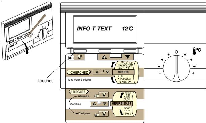
*En cas de fausse manœuvre, l'action de fermer puis rouvrir la porte du module permet de reprendre la procédure au début.*
