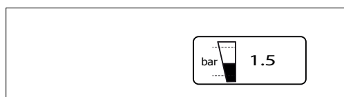
Fig.56 Pression de l'installation affichée à l'écran
