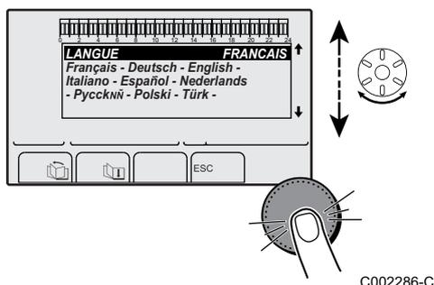
4. A la première mise sous tension, le paramètre **#LANGUE** s'affiche. Sélectionner la langue souhaitée en tournant le bouton rotatif.
