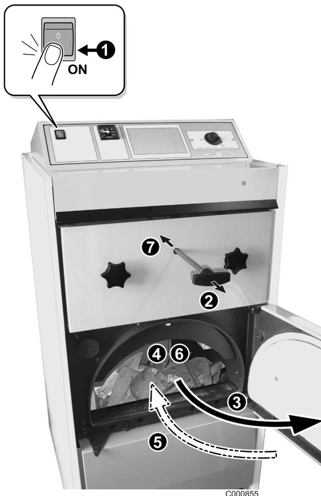
1. Mettre l'interrupteur Marche/Arrêt sur 1.
