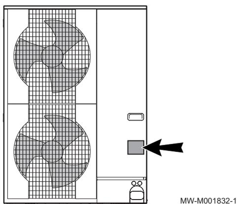
1. Relever la puissance et le type, notés sur la plaquette signalétique du module extérieur.
