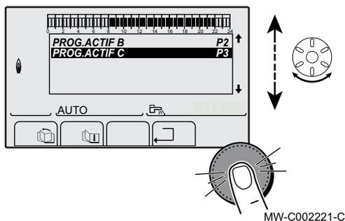
4. Pour modifier le paramètre, appuyer sur le bouton rotatif.
