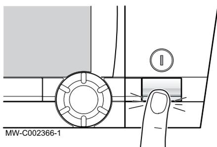
2. Mettre sous tension en activant l'interrupteur marche/arrêt du module intérieur.
