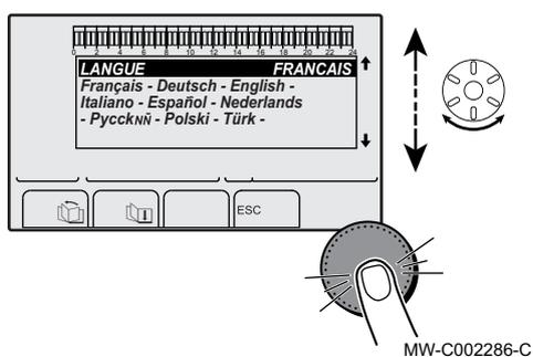
3. A la première mise sous tension, le paramètre **LANGUE** s'affiche. Sélectionner la langue souhaitée en tournant le bouton rotatif.
