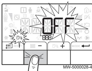
4. Sélectionner l'arrêt de la production d'eau chaude sanitaire en appuyant sur la touche **-**.
