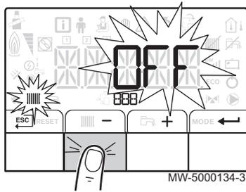
4. Sélectionner l'arrêt du chauffage en appuyant sur la touche **-**.
