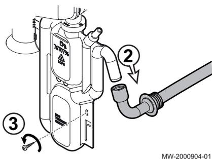
2. Démontez le tuyau d'évacuation des condensats.
