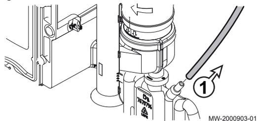
1. Démontez le tuyau d'évacuation de la buse des fumées.
