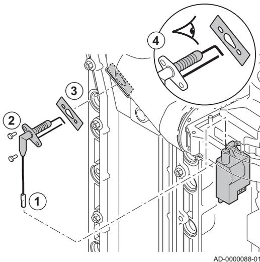
L'électrode d'ionisation/d'allumage doit être remplacée si :
