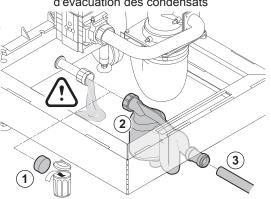
1. Retirer le capuchon de protection du raccordement de condensat.
