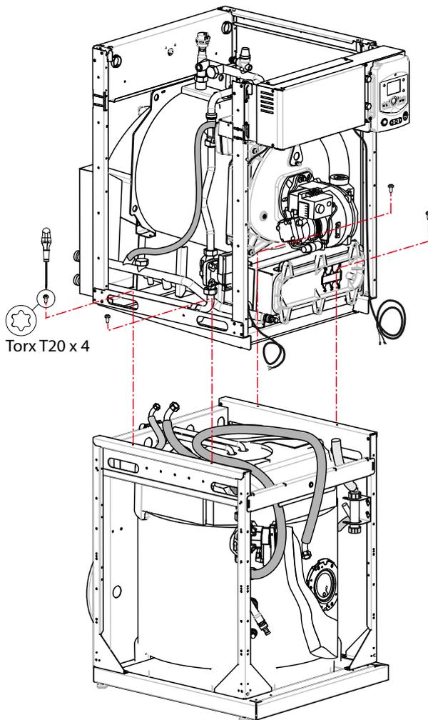
fig. 12 - Désolidarisation du module corps de chauffe
