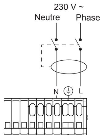
fig. 26 - Protection différentielle
