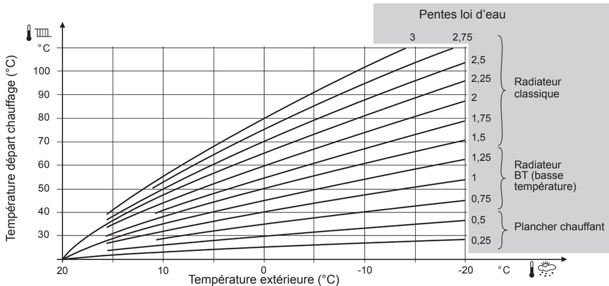
fig. 40 - Pente de la courbe de chauffe (ligne 720)
