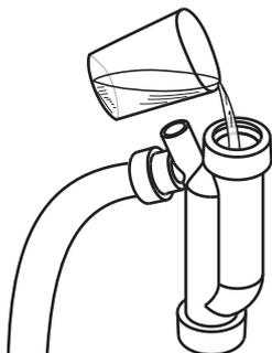
*fig. 23 - Remplissage du siphon*
