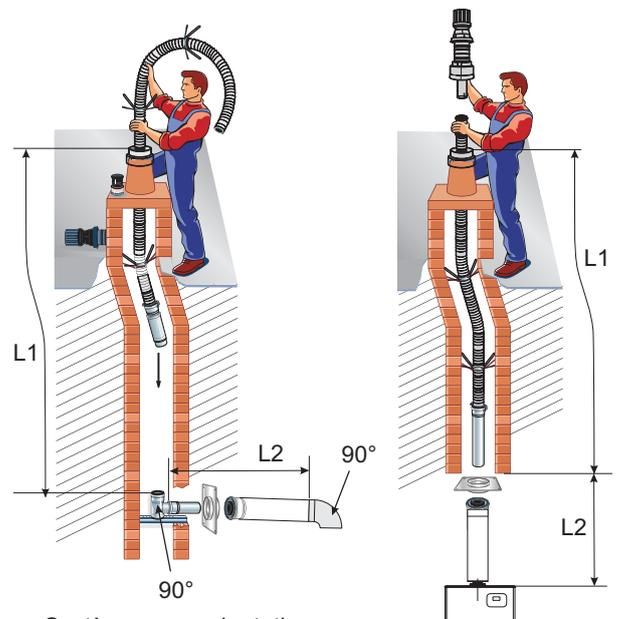
Système pour adaptation sur conduit d'évacuation existant (avec prise d'air dans la cheminée).
