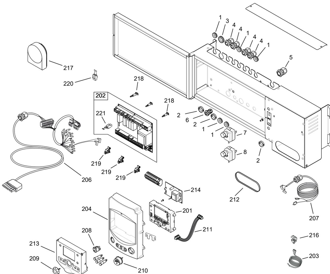
fig. 42 - Vue éclatée (tableau de contrôle)
