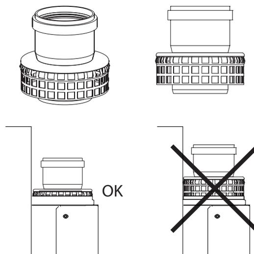
fig. 18 - Montage de l'adaptateur cheminée 073295 (B23, B23P)
