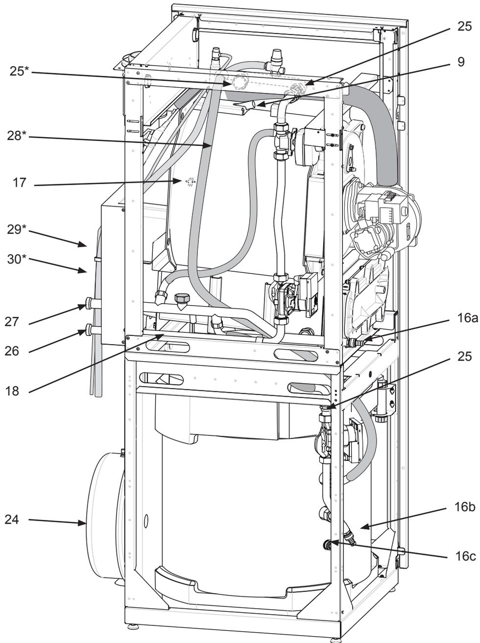
fig. 7 - Organes de l'appareil (avec kit 2<sup>ème</sup> circuit sur pompe, vue de côté)
