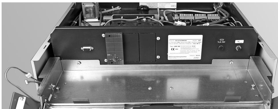
fig. 32 - Accès au coffret électrique
