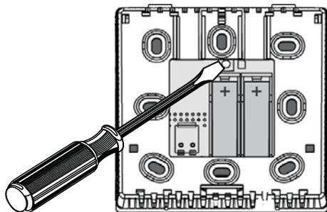
Appuyez 10 s. sur le bouton satellite au dos du boîtier de sonde extérieure. Pour réaliser sa connexion, la sonde envoie des signaux (cela peut durer quelques minutes) jusqu'à être reconnue par le thermostat d'ambiance qui valide alors la connexion par l'affichage :
