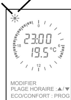
Ce symbole indique le mode autorisant la suppression de carrés noirs pour mettre en place des plages de fonctionnement à température dite **ECO** à l'aide des touches ▼/▲.
