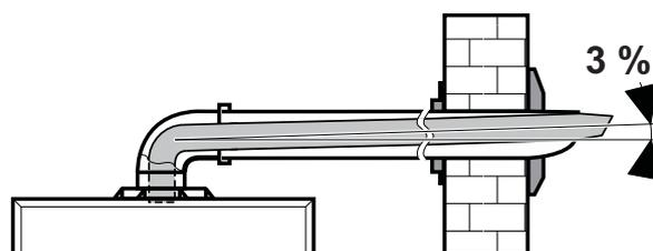
La ventouse horizontale Saunier Duval donne automatiquement un angle de 3° permettant le retour des condensats vers l'appareil.
