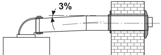
La ventouse horizontale Saunier Duval donne automatiquement un angle de 3° permettant le retour des condensats vers l'appareil.
