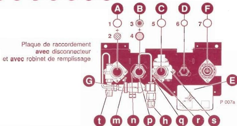
Plaque de raccordement avec disconnecteur et avec robinet de remplissage
