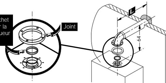
Système ventouse double flux 2 x Ø 80 mm (installation de type C52)
