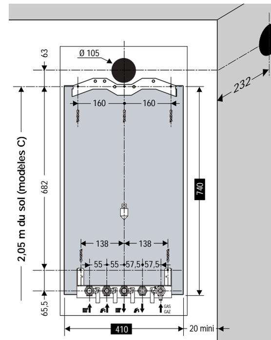
L'applique de raccordement sert de gabarit de montage. Elle permet de réaliser tous les raccordements sans que la chaudière soit en place. Elle se compose d'une plaque de raccordement, d'une barrette de fixation et d'un gabarit de pose. La mise en place de l'ensemble doit être effectuée conformément au descriptif dessiné sur le gabarit.
