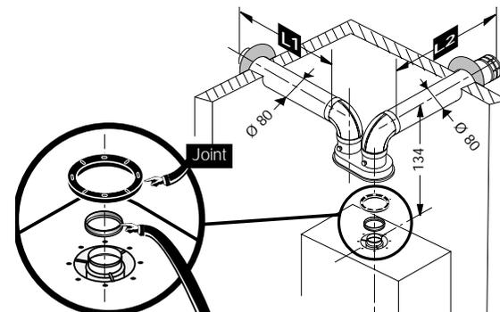
Le diaphragme fourni dans le sachet de joint doit être mis en place sur la sortie fumée dès lors que la longueur (L1+L2) est inférieure à 6 m.
