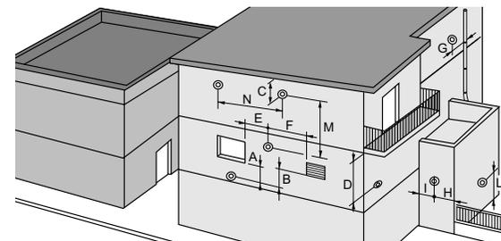
Le diaphragme fourni dans le sachet de joint doit être mis en place sur la sortie fumée dès lors que la longueur (L) est inférieure à 0,5 m.
