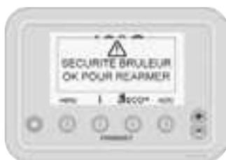
**⚠** **AVERTISSEMENT** : Avant de procéder à l'allumage du brûleur, la chaudière effectue un auto contrôle qui peut durer jusqu'à 2 minutes. Ensuite l'appareil entame son mode normal de fonctionnement et le brûleur s'allume. Lors d'une première tentative d'allumage, une anomalie «Sécurité Brûleur» peut s'afficher à cause d'une purge gaz insuffisante. Relancer le cycle d'allumage plusieurs fois si nécessaire en appuyant sur la touche « OK ».
