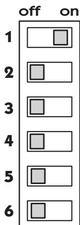
Doit impérativement être basculé à droite durant toute opération de vidange ou de remplissage. Ensuite, basculer (à gauche) pour mettre en "marche normale".
