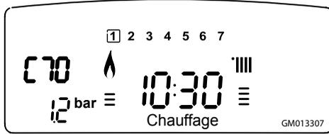
Si la fonction confort n'est pas active la réserve d'eau sanitaire n'est pas maintenue en température. La chaudière agit comme une chaudière instantanée, la fonction sanitaire est assurée uniquement lors de puisage sanitaire.
