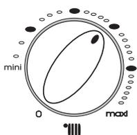
Le commutateur **22** permet d'ajuster la température de l'eau du circuit départ chauffage en fonction des besoins saisonniers :
