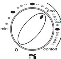
Le commutateur **23** permet d'ajuster la température de l'eau sanitaire entre les positions mini et confort. Pendant ce réglage, l'afficheur clignote et indique la température moyenne de consigne de stockage de l'eau chaude sanitaire.
