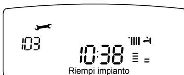
Vérifier la pression sur le manomètre et procéder au remplissage par le disconnecteur placé sur la barrette. Fermer le disconnecteur dès que la pression atteint 1 - 1,5 mbar.
