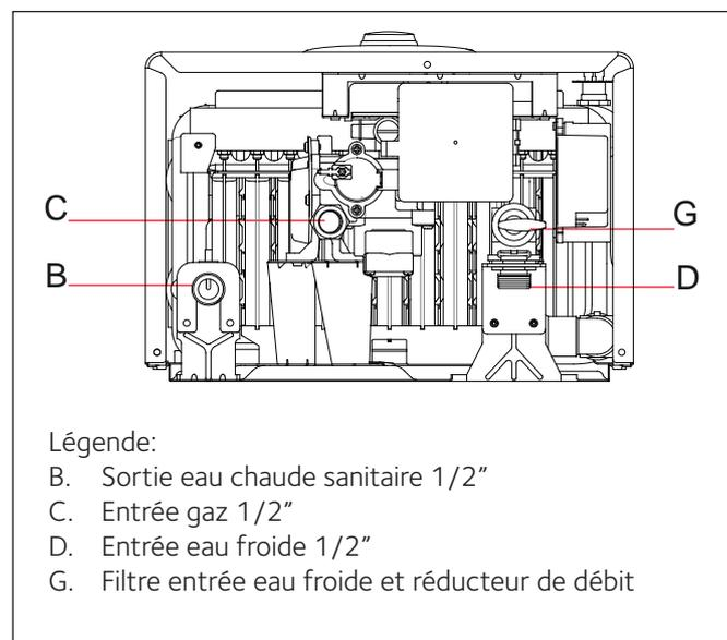
L'appareil est équipé d'un filtre "G" sur l'entrée eau froide. En cas de saleté dans l'eau à nettoyer périodiquement.
