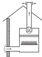
**C52** Évacuation des fumées à l'extérieur et aspiration de l'air à travers un mur extérieur pas dans le même champ de pression
