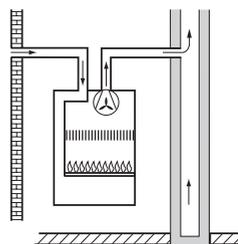
**C82** Évacuation des fumées dans le tuyau d'évacuation simple ou collectif intégré à l'édifice
