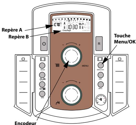
(Encodeur : Bouton de réglage permettant d'augmenter ou diminuer la valeur de réglage)
