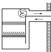
**C32** Évacuation des fumées et aspiration d'air venant de l'extérieur avec terminal en toiture dans le même champ de pression
